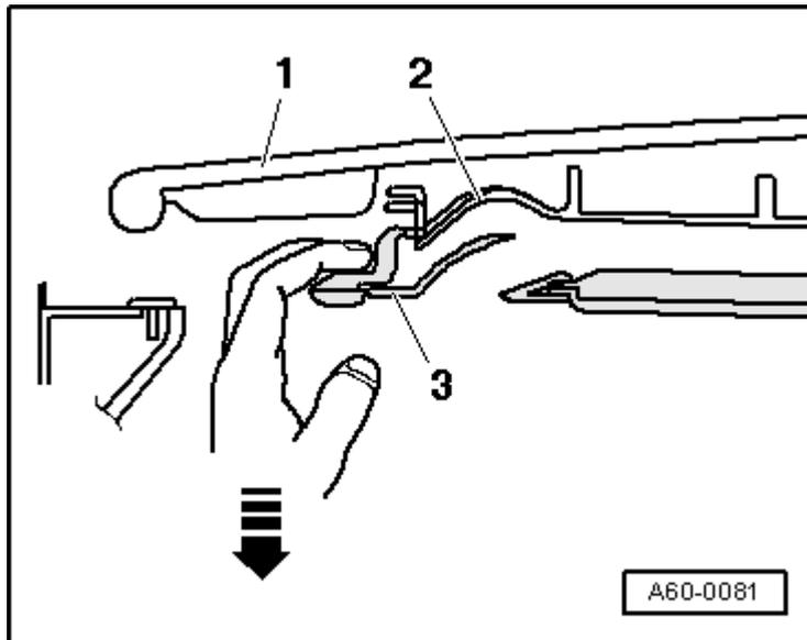
Si la posición cero está correctamente ajustada, el perno guía -1- del elemento deflector tiene que coincidir centradamente con la marca -flecha- de la guía de corredera -2-.
