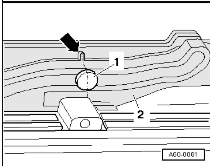
Al hacerlo, el elemento de arrastre -2- se tiene que introducir en la guía -1- de la parte posterior de la pantalla interior del techo corredizo.
